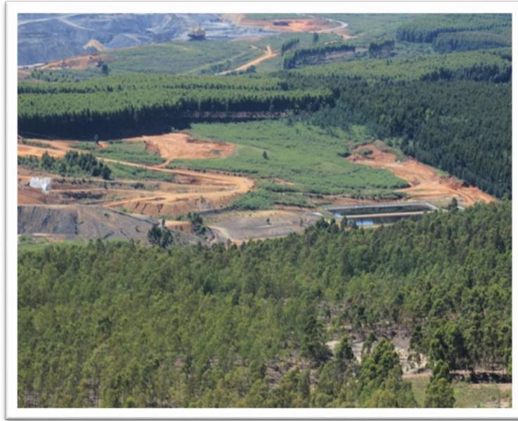
**Figura 21** – Lagoas de estabilização de para tratamento de lixiviados no aterro sanitário Metade Sul – Candiota/RS
